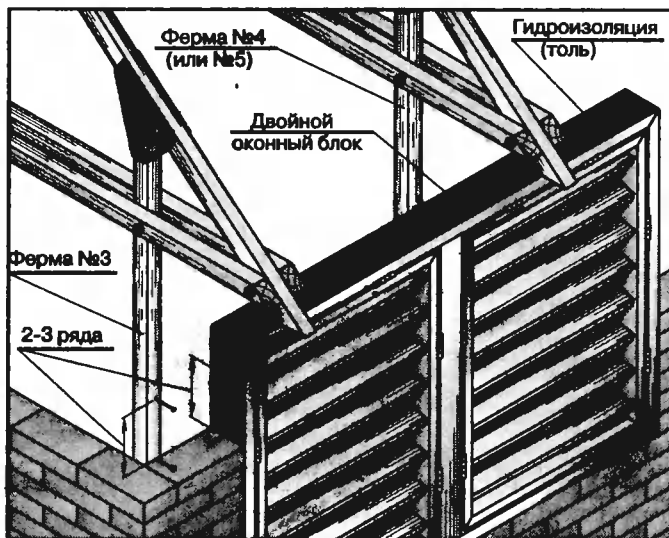
Рис. 12. Средняя стойка оконного блока должна точно совпадать со стойкой фермы №4 или №5
